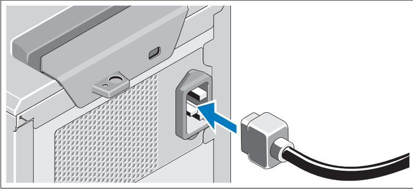
Conecte el cable de alimentación al sistema y, si se utiliza un monitor, conecte el cable de alimentación correspondiente al monitor.
